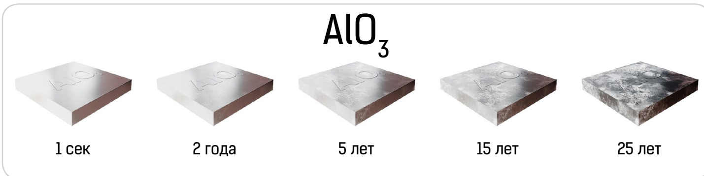
Оксид алюминия образуется и растет на поверхности проводника с момента производства
